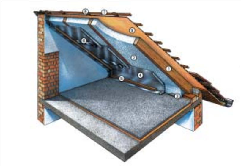
Bild 17: Beispiel eines Dachaufbaues, der auch die Leistungsflussdichte elektromagnetischer Wellen reduziert (Fa. Dörken)
