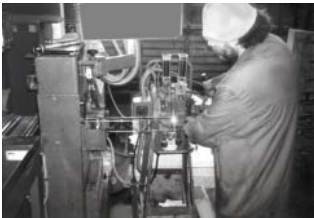
Elektro-Schweißanlage für Baustahlgewebe mit einer Leistung von 10 kVA
